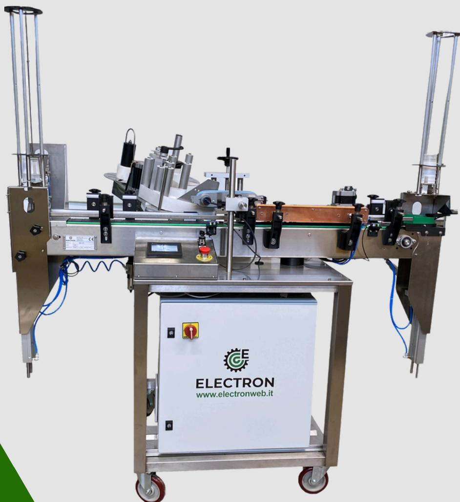
**Impianto di etichettatura per contenitori in plastica di forma leggermente tronco-conica, dotato di un sistema automatico per il prelievo del contenitore dal caricatore dedicato e successivo impilaggio dei prodotti etichettati.**
