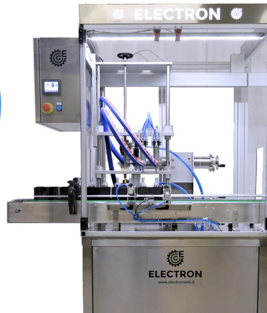
Linee di riempimento di tipo volumetrico ed in leggera depressione, per prodotti liquidi, oleosi e viscosi. Possono essere equipaggiate con:
